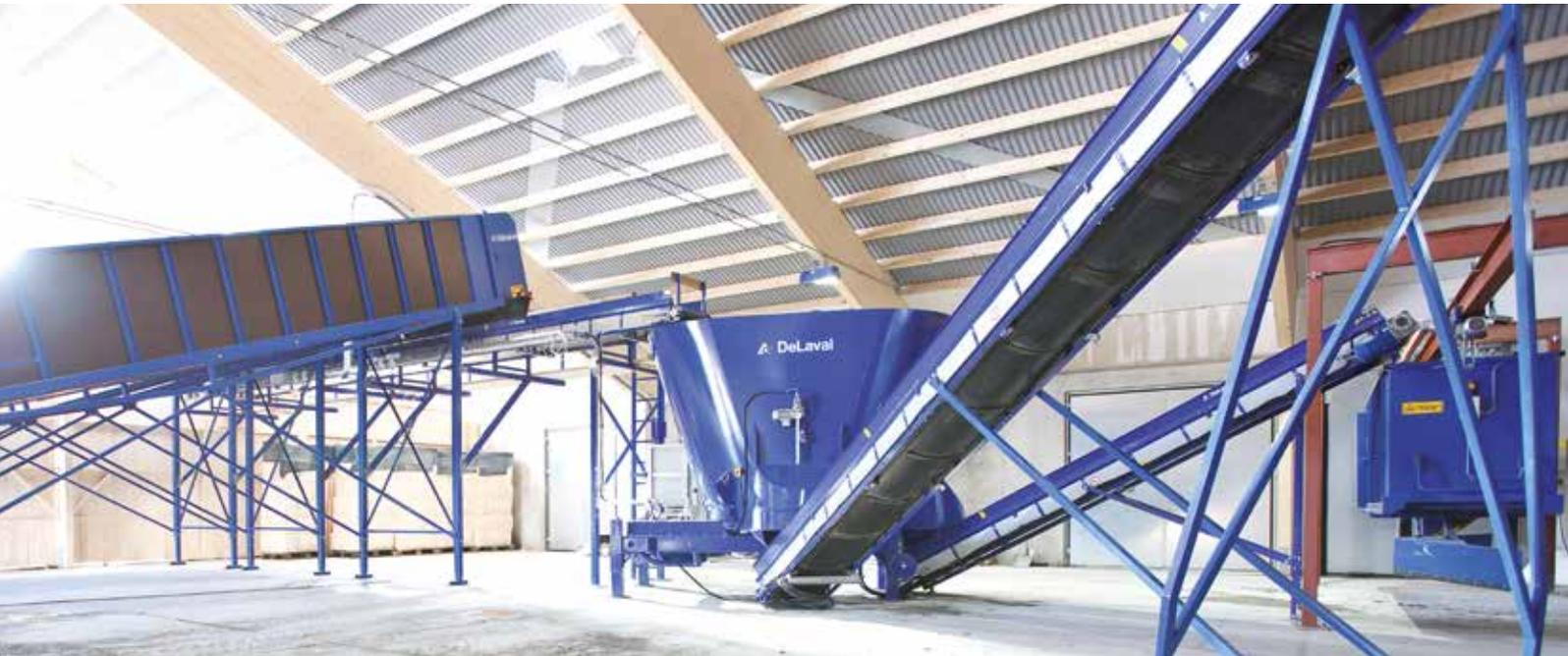
Das Optimat™ System basiert auf einer Vernetzung von Spezialisten für jeden Arbeitsschritt. Ein robuster vertikaler Stationärmischer sorgt für eine gründliche Mischung aller zu ladenden Komponenten bis hin zu Rundballen. Ein frequenzgesteuerter Motor sorgt dafür, dass immer nur die Leistung abgerufen wird, die auch wirklich benötigt wird.
